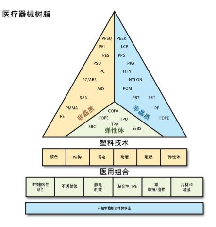
此图说明了我们如何通过考虑环境因素(例如耐化学性、温度和湿度)、器械生命周期和器械的整体功能等特性来缩小医疗器械的基体树脂选择范围。选择基体树脂后,我们会考虑所需的其他技术,例如颜色或结构增强,然后从我们医用组合中的产品开始开发定制配方。我们医用组合的基础是已知经过生物相容性测试并符合 FDA 要求的材料数据库,我们使用该数据库来开发定制配方,以满足对医疗器械的专业要求,例如生物相容性、放射不透性、静电耗散、符合人体工程学的弹性体、低摩擦、医用薄膜、耐化学性和灭菌。
